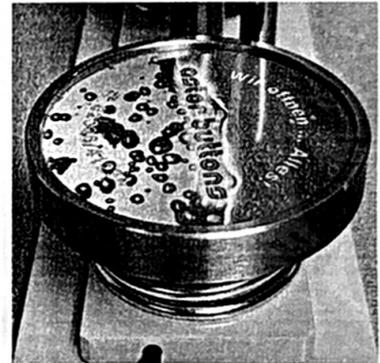
3. Das Werkzeugunterteil "1" mit dem eingelegten Button-Oberteil, dem Druck und der Folie nach hinten schwenken und durch das runterdrücken des Handhebels, das Button-Oberteil mit dem Druck und der Folien in das Werkzeugoberteil einziehen.
